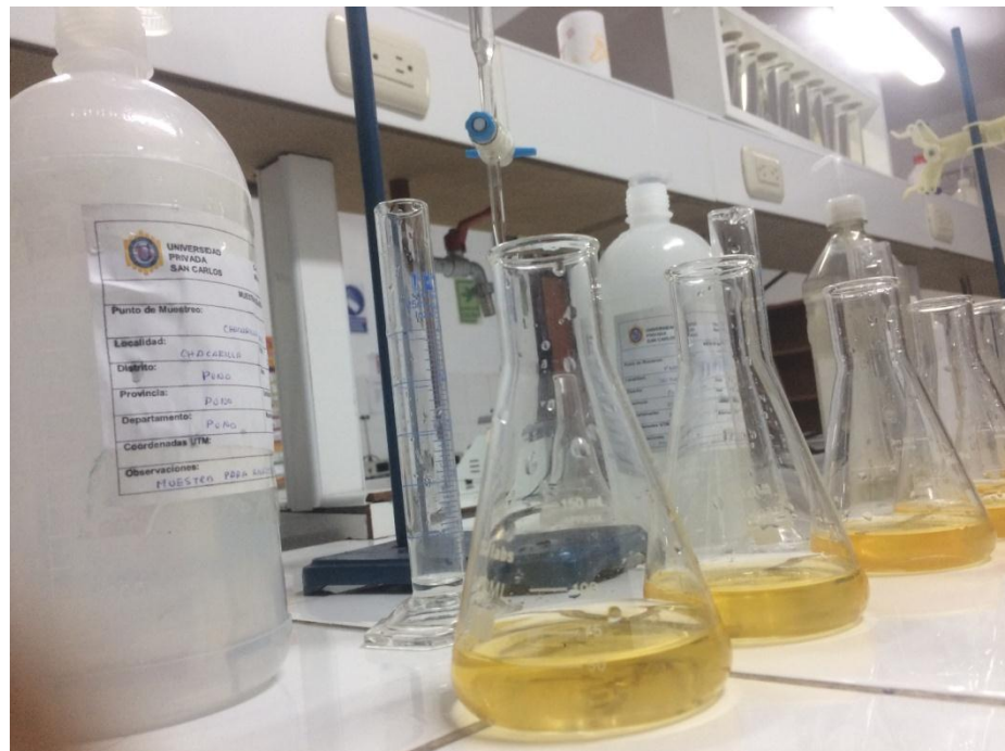
Figura 26: Viraje después de la aplicación de reactivos en las muestras de agua.
